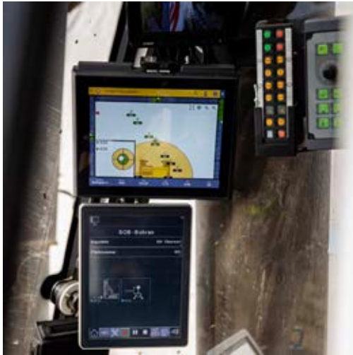
Der zusätzliche LIPOS-Monitor in der Kabine zeigt dem Fahrer jederzeit die genaue Position der Liebherr-Maschine an.
